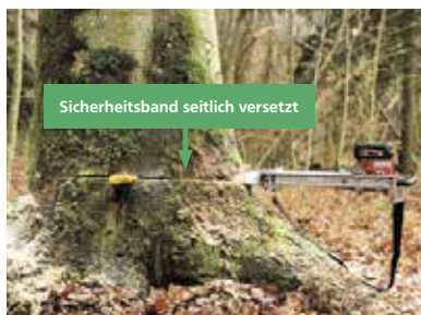
Abb. 1: Mechanischer Fällkeil im Schnabelschnitt.
