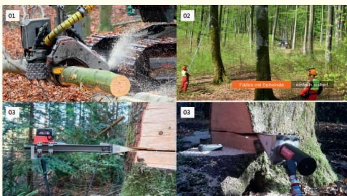
Sichere Arbeitsverfahren sind: Einsatz eines Harvesters (01), seilwindenunterstützte Fällverfahren (02); Einsatz von fernbedienbaren technischen Fällkeilen (03). Bildquelle: SVLFG
